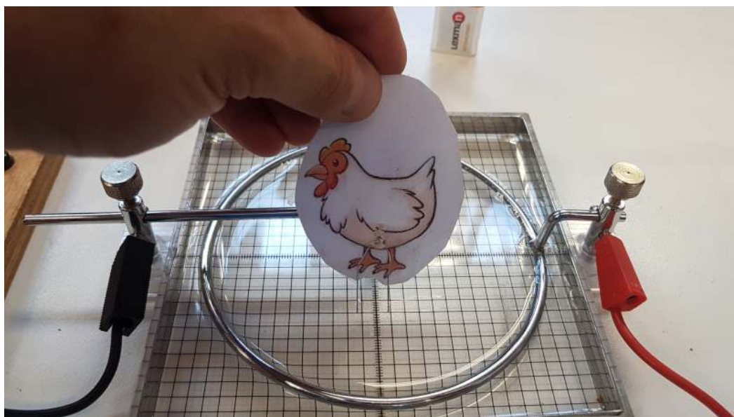
Εικόνα 9: Το LED δεν ανάβει αν τοποθετήσουμε την κότα με τα πόδια της τοποθετημένα εφαπτομενικά σε σχέση με τον «κεραυνό»
