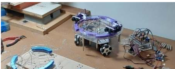
Εικόνα 16. Συναρμολόγηση ρομποτικής πλατφόρμας 3WD
