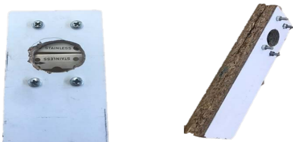
Εικόνα 11: (α) Τα ξυραφάκια που σχηματίζουν γωνία, (β) η τομή, η πίσω όψη και η στήριξη
