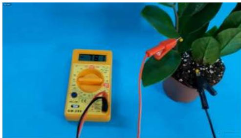
Εικόνα 1: Μέτρηση διαφοράς δυναμικού ανάμεσα στον μίσχο του φυτού και στο έδαφος
