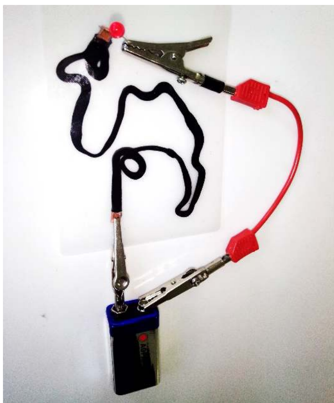
Εικόνα 20 Σύνδεση του γραμμικού σχεδίου σε κύκλωμα
