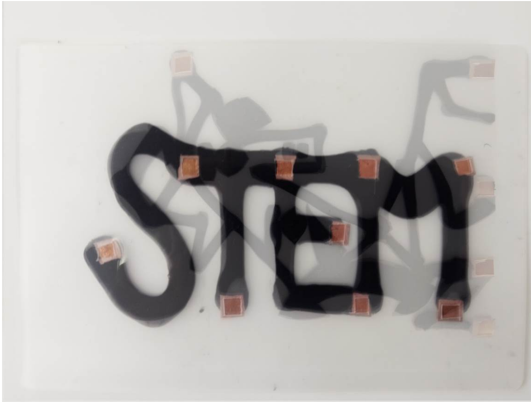
Εικόνα 10 Κύκλωμα με αγώγιμη πλαστελίνη
