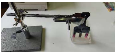
Εικόνα 2: Κατασκευή των θέσεων υποδοχής των δειγμάτων στην πηκτή
