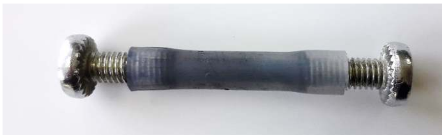
Εικόνα 6 Ο πρώτος αντιστάτης ΑΠ που κατασκευάστηκε τιμής 10,8Ω
