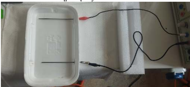
Εικόνα 5: Συσκευή ηλεκτροφόρησης από φελιζόλ
