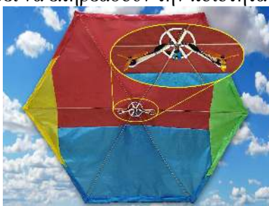
Εικόνα 2 : Ο χαρταετός μας εξοπλισμένος με κινητήρες, κάμερες, αισθητήρες θερμοκρασίας, βαρομετρικής πίεσης και φωτεινότητας
