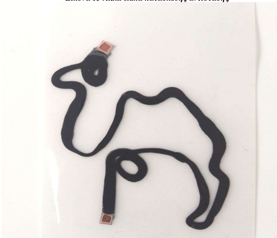
Εικόνα 14 Γραμμικό σχέδιο του Πικάσο από αγωγίμο υλικό
