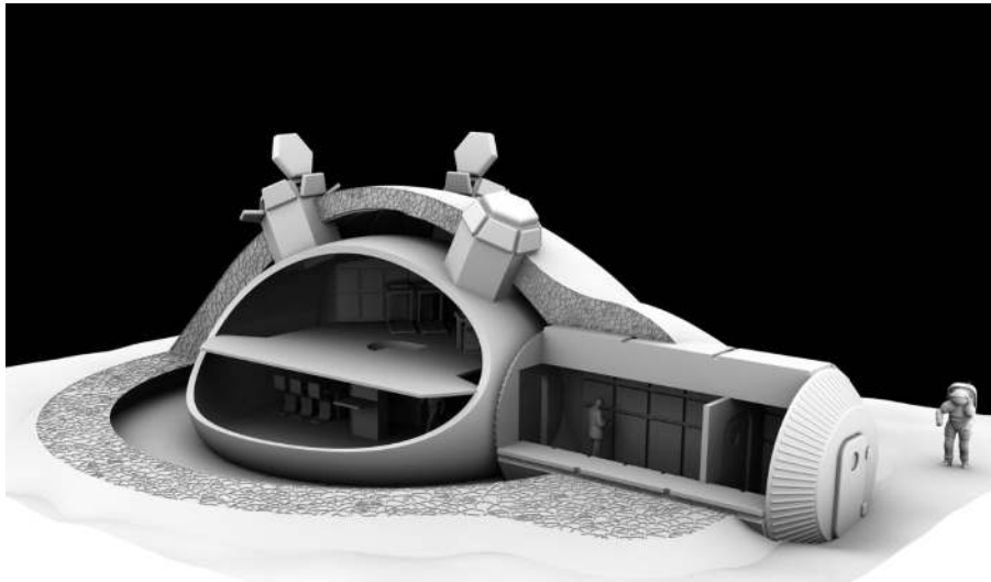
Εικόνα 6: Κατασκευή Σεληνιακής Βάσης. Εξωτερικά: Υλικό από ρεγόλιθο. Εσωτερικά: Πτυσσόμενη φουσκωτή βάση (εισαγωγή εικόνας από https://www.esa.int/var/esa/storage/images/esa_multimedia/images/2013/01/3d-printed_lunar_base_design/12501079-1-eng-GB/3d-printed_lunar_base_design_pillars.png )
