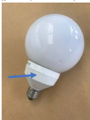
Εικόνα 4: Συμπαγής λάμπα φθορισμού. Το τόξο δείχνει που βρίσκεται το ηλεκτρονικό μέρος
