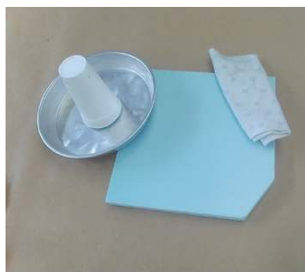
Εικόνα 3: Ηλεκτροφόρος με απλά υλικά
