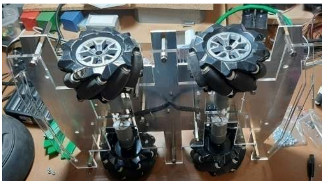
Εικόνα 12. Τοποθέτηση κινητήρων και mecanum wheels στη ρομποτική πλατφόρμα 4WD.
