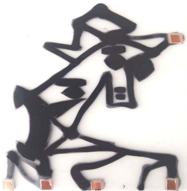
Εικόνα 15 Γραμμικό σχέδιο του Πικάσο από αγώγιμο υλικό
