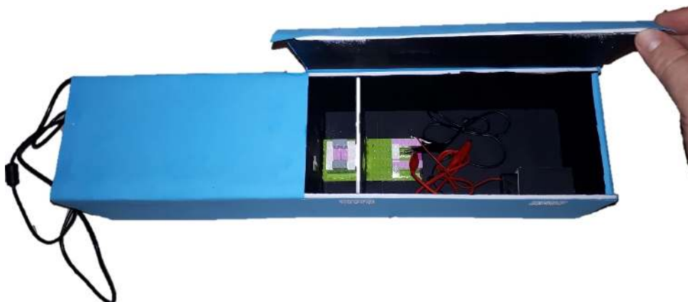
Εικόνα 2: Η τελική αναλυτική μας συσκευή. Διακρίνονται η πηγή, η θήκη των μπαταριών και η θέση της κυψελίδας. Η κάμερα βρίσκεται εντός του οργάνου στα αριστερά και δεν είναι προσβάσιμη στον χρήστη.
