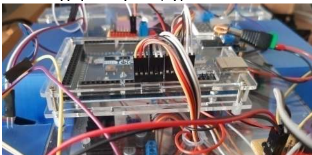
Εικόνα 14. Τοποθέτηση μ/ε Arduino Mega 2560 R3 στη ρομποτική πλατφόρμα 4WD
